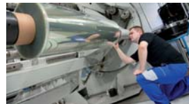
Prüfung kantengerades Aufrollen
