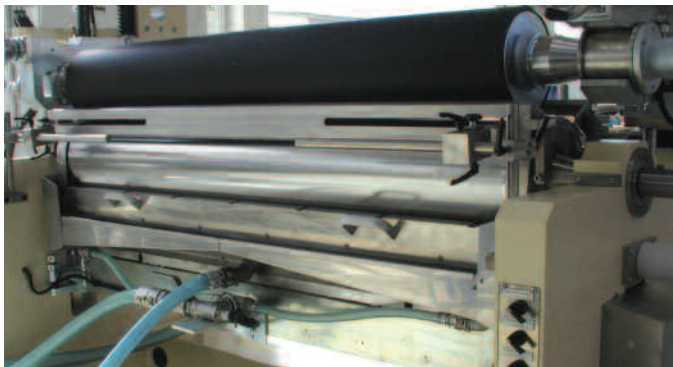
Auftragswerk mit Druckkammerrakel und Rasterwalze. Auch als Ausführung auf Wechselwagen möglich
