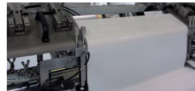
MWC (Multi Wet Curtain) Auftragswerk mit Kaskadendüse
