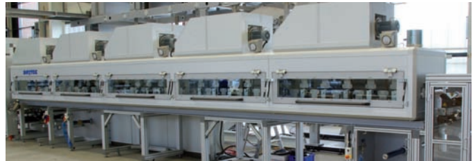
Abb. 5: Design einer LabCo für die Herstellung von Batterieelektroden
