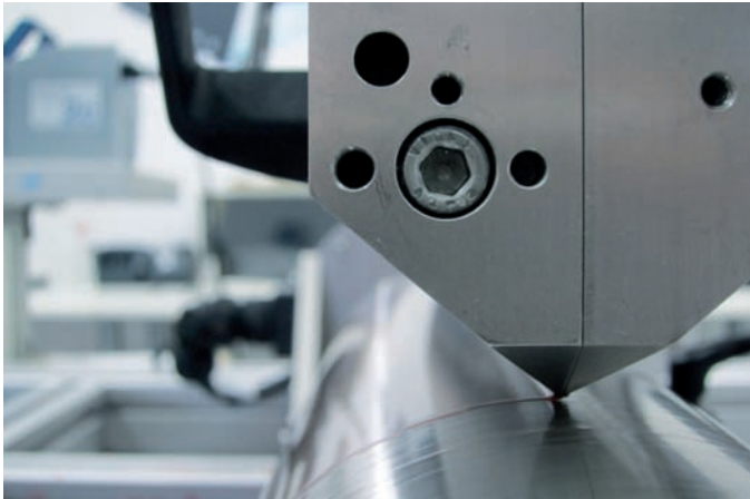
Abb. 3: Bead Coat - Düsenauftragstechnologie zur Applikation von sehr dünnen Schichten
