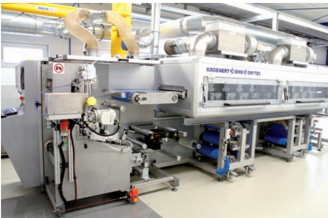
Abb. 1: Laborbeschichtungsanlage LabCo im Technology Center von KROENERT, BMB und DRYTEC
