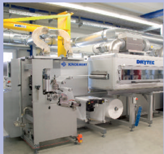
Das Kroenert-Technologiezentrum hat Zuwachs bekommen: Nun steht dort auch diese Schmalbahnanlage LabCo für Bahnbreiten bis 500 mm
