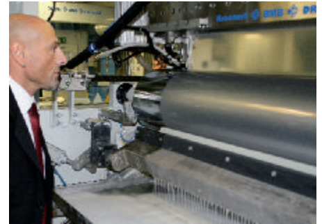
Im ersten Versuchslauf wurde ein herkömmlicher Vorhang aufgebaut ...
