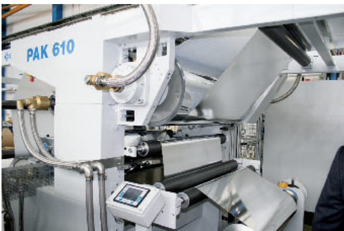
Die PAK 610 beim Testlauf mit einer Alu-/Papier-Kaschierung
