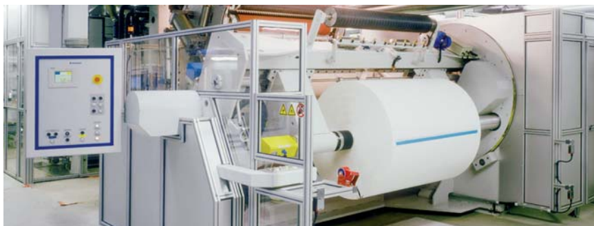
Abwickler FSU 10 AG für 2 Rollen bis 1.300 mm Durchmesser
