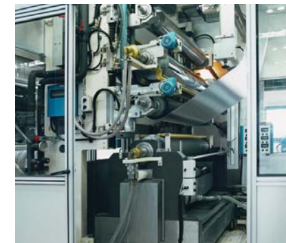
Alle Auftragssysteme sind schnell wechselbar durch Einbau im Trolley-System
