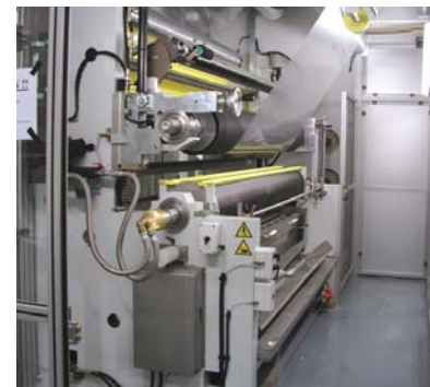
Das Auftragssystem ist fest im Auftragswerk installiert, aber wechselbar
