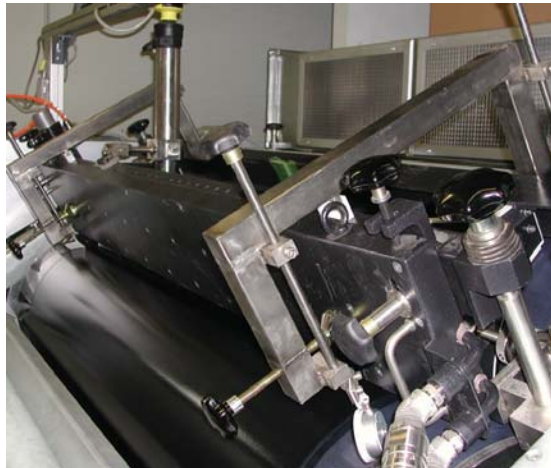
1.650 mm breites Epoxidharz-Auftragswerk für Anwendungen in der Luftfahrt, Automobil- und Sportindustrie
