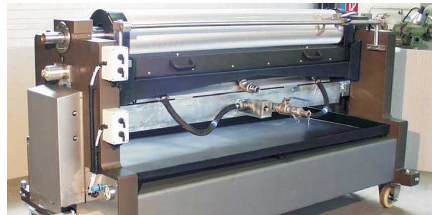
Druckkammerrakel mit Rasterwalze; hochpräzise Kammeranstellung mittels vertikaler Verfahrbarkeit
