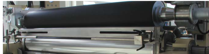
Die druckbefüllte Kammerackel kombiniert die Vorteile des Raster-Walzenauftrags-systems mit der Geschlossenheit einer Düse
