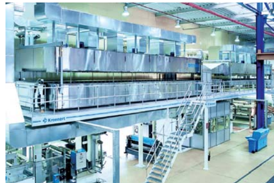
Hochgeschwindigkeits-Lackieranlage für 1200 m/min
